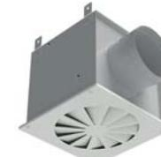
Диффузоры с рекомендуемой высотой установки до 4.5 м. Диффузор вихревой закручивающий с фиксированной геометрией струи, имеет ряд неподвижных радиальных лопастей.
