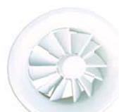
Диффузоры идеально подходят для помещений с высокой разницей температуры между поступающим воздухом и воздухом в помещении. Положение лопаток диффузора можно изменять в зависимости от сезона таким образом, чтобы обеспечить в рабочей зоне максимальную комфортную температуру вне зависимости от подачи теплого воздуха (вертикальная струя) или холодного воздуха (горизонтальная струя). \*Возможность установки электропривода.
