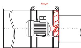
**Монтаж при переходе с большего или на больший диаметр**
