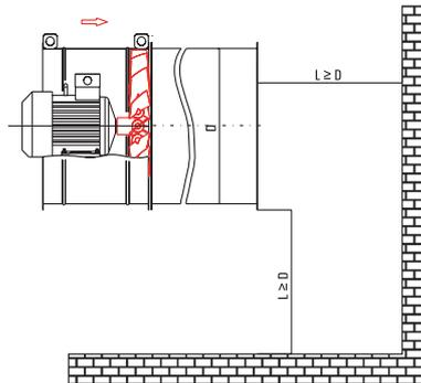
**Монтаж выходного диффузора**
