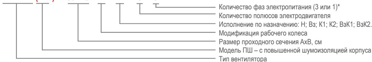
\* – однофазные электродвигатели могут устанавливаться взамен 3-х фазных при мощности 5.5 кВт и ниже.
