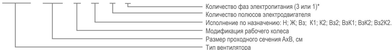
\* – однофазные электродвигатели могут устанавливаться взамен 3-х фазных при мощности 5.5 кВт и ниже.
