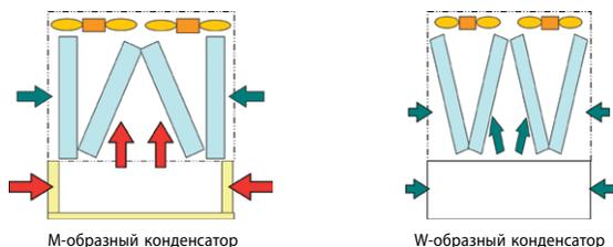
• Конденсатор состоит из бесшовных медных трубок и алюминиевых ребер-пластин. Ребра имеют усовершенствованную гофрированную поверхность с небольшими впадинами. Благодаря такой конструкции эффективность теплообмена возросла примерно на 8% по сравнению с конденсатором, оснащенным алюминиевыми ребрами предыдущего поколения.
