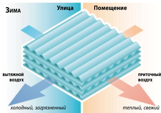
• Теплообменник выполнен из высококачественной бумаги. Канавки каждого листа повернуты на 90° по отношению к канавкам смежных листов. Таким образом, они формируют перекрестные воздушные каналы, через один из которых вытяжной воздух выводится наружу, а через соседний поступает приточный. Листы бумаги чередуются с цельноштампованным элементом,
