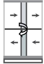
Эффективность рекуперации составляет 70—90%. Допускается частичное (не более 3%) смешение отработанного и приточного воздуха;
