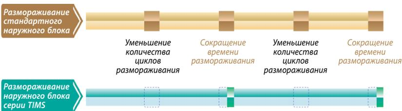
Каждый модуль комбинированного наружного блока размораживается попеременно. Благодаря этому предотвращается резкое понижение температуры в кондиционируемых помещениях.
