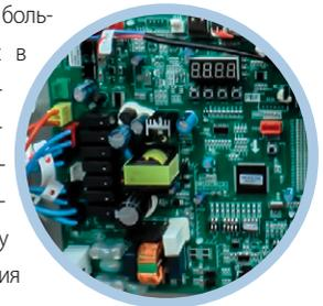
В случае непредвиденного отключения питания плата автоматически восстанавливает заданные пользователем параметры (они записываются устройством хранения данных Black Box), после того как подача питания возобновляется. Таким образом, повторная настройка VRF-системы не требуется.
