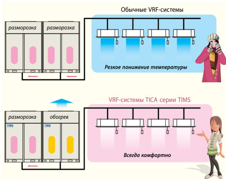
В VRF-системах TICA используется уникальная конструкция, препятствующая обледенению нижней части наружного блока при его эксплуатации в режиме обогрева. При размораживании в холодное время года она позволяет полностью избавиться от воды и льда в нижней части агрегата. Благодаря данной конструкции время его размораживания сокращается на 30%.
