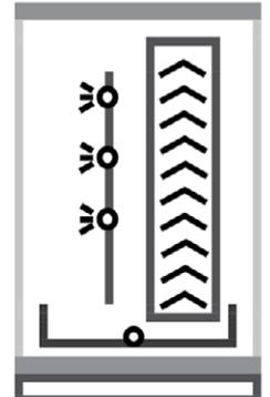
Секция форсуночного увлажнителя высокого давления
