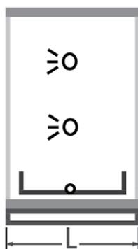
**Секция рекуператора (теплоутилизатора)**
