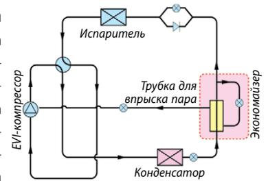
• Благодаря вышеописанной EVI-технологии диапазон рабочих температур спирального компрессора значительно расширяется (наружный блок мини VRF-системы серии TIMS-АНТ(СНТ)/АНТА может работать при температуре окружающей среды от -5 до +50 °С в режиме охлаждения и от -30 до +24 °С в режиме обогрева), а его теплопроизводительность возрастает на 20% по сравнению с обычным спиральным компрессором.
