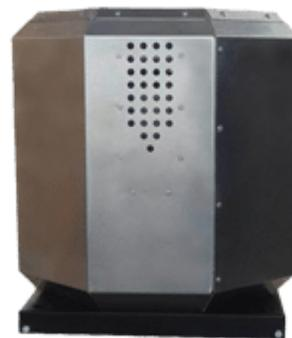
Устройство имеет функцию непрерывной работы при 120 ° С. Вертикальный вытяжной вентилятор для кухни изготавливается подходящее для вытяжных устройств кухни, также имеет класс защиты IP55. Вертикальный выброс воздуха обеспечивается благодаря радиальному рабочему колесу вентилятора лопасти в сборе, чтобы гарантировать вертикальный выброс.
