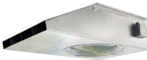
Струйные вентиляторы Cvsaig с радиальной крыльчаткой, которые могут работать в режиме двойной вентиляции, как для ежедневного вентилирования, так и при пожаре с двигателем 750 / 1,500 об / мин. В соответствии с EN 12101-3 изготовлены со стойкостью F300 (300 ° / 120 мин.) и F400 (400 ° / 120 мин.). На стороне всасывания устройств имеется защитная сетка. Электрические клеммные коробки радиального струйного вентилятора также изготавливаются с огнестойкостью.
