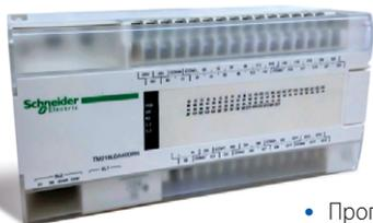
• Каждый чиллер серии TWSF оснащен программируемым логическим контроллером линейки TM, выпускаемым французской компанией Schneider Electric.
