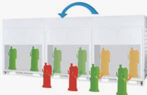
Errore Slave 1, l'unità non funziona, entra in stato di standby, gli altri moduli possono ancora funzionare. Slave 1 error, forbid run, come into standby state, the other modules can still work.
